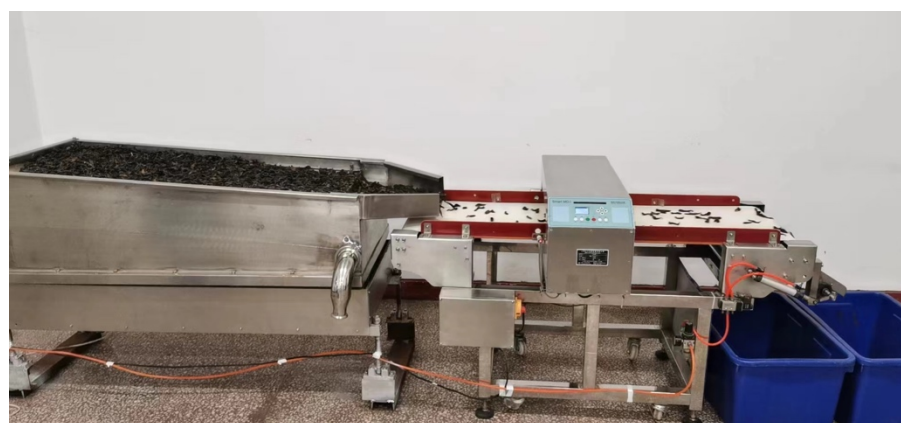
图 12 金属检测机对水蛭（蚂蟥）药材进行金属杂质检测（型号：Smart MD-I）
